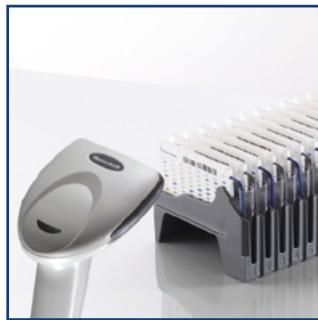
Escanee los códigos de barra de la tarjeta y la cepa para establecer la trazabilidad.
