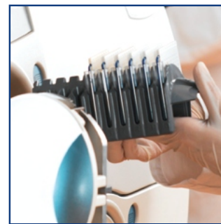
VITEK® 2 COMPACT: Las tarjetas son inoculadas dentro del instrumento y transferidas manualmente desde la puerta de llenado a la puerta de carga para procesar
